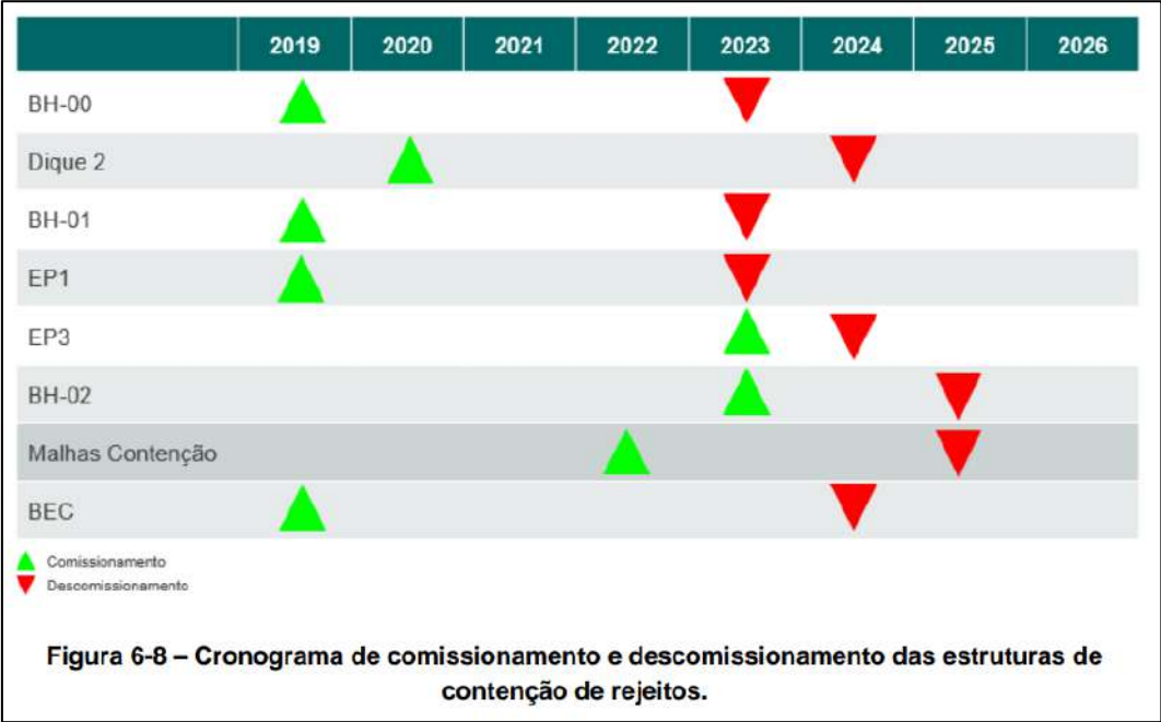
Figura 2 – Resumo das previsões para comissionamento e descomissionamento das estruturas de contenção de rejeitos durante os anos.
