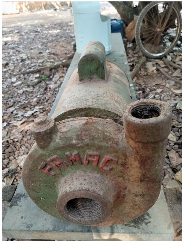
Figura 7: Bomba que ficava no rio Paraopeba para encher o reservatório de irrigação.
