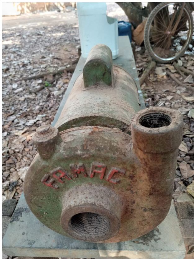
Figura 7 - Bomba que ficava no rio Paraopeba para encher o reservatório de irrigação. Foto: Instituto Guaicuy.
