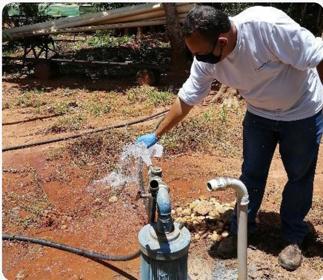
FIGURA 1 — Coleta de água subterrânea em um poço tubular
