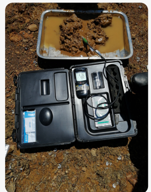
Medições de parâmetros físicos e químicos dos sedimentos das margens
