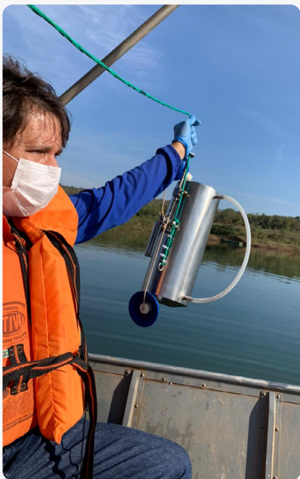
Lançamento da Garrafa de Van Dorn para coleta de água em profundidade
