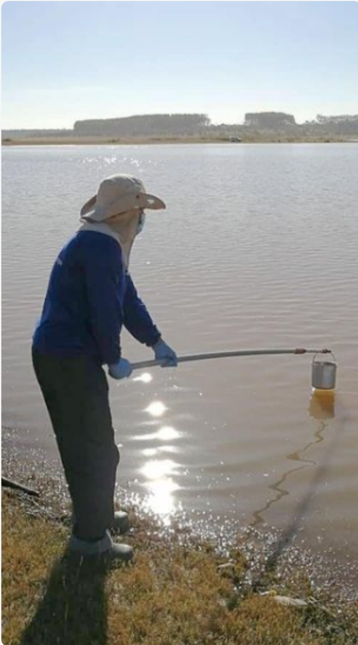
Coleta de amostra de água na margem
