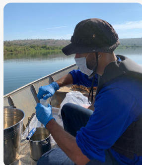
Coleta de amostras de água no centro dos ambientes (região limnética dos reservatórios ou calha central do rio)
