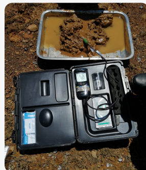
Medida de parâmetros físicos e químicos da água em campo.
