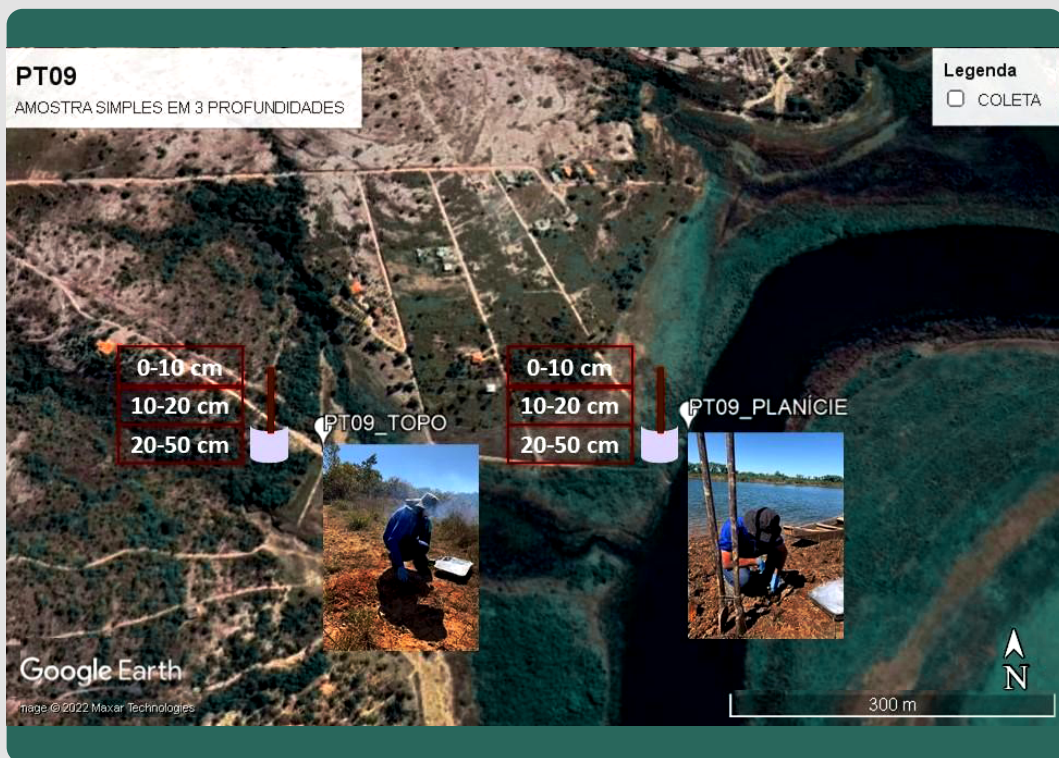
FIGURA 5 – Amostragem simples em três profundidades na planície e no topo
